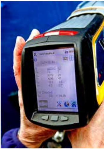
Mätinstrumentet är kalibrerat för mätning av metaller på plastskrov.
