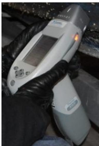
Bild 1. XRF-scannern av märket Niton XLt som använts vid mätningarna.
