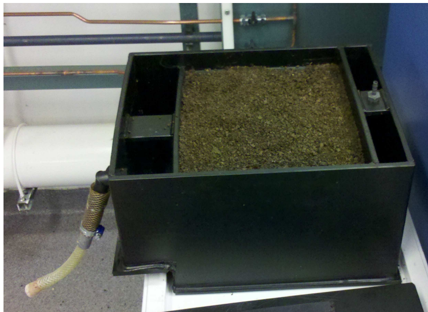
Figur 2. Torvfilterssystemet som användes för laboratorieförsöket.
