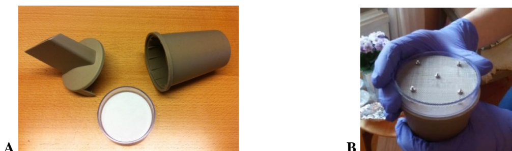
Figur 1. Provtagningsmaterial som användes för insamling av dammprover. A: Filterinsats med monterat cellulosafilter samt tvådelat munstycke. B: Montering av den sil som användes för att filtrera damm inför analyser av flamskyddsmedel.
